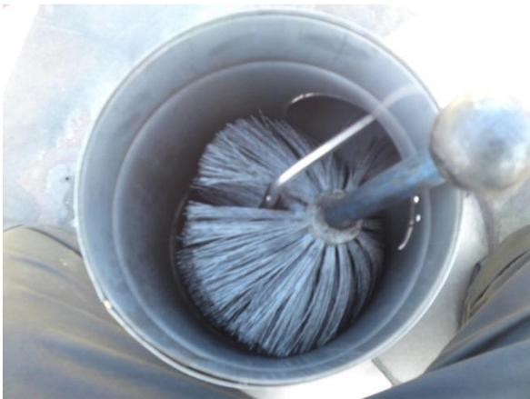
Bürste im Bereich der Elektrodenführung
