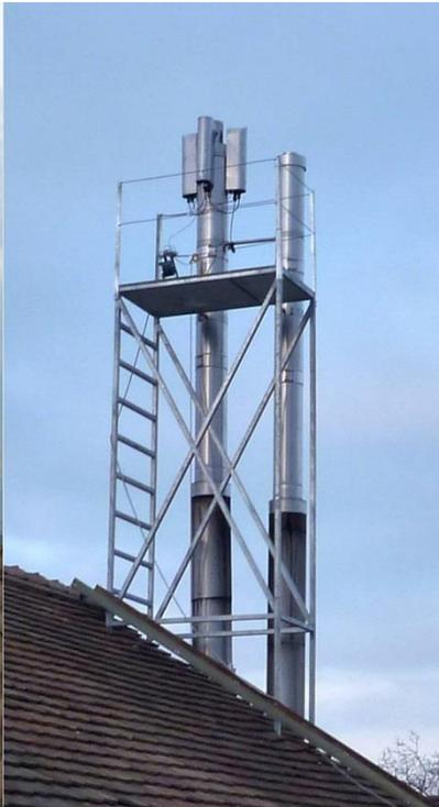
Teststand für Kaminfilter
